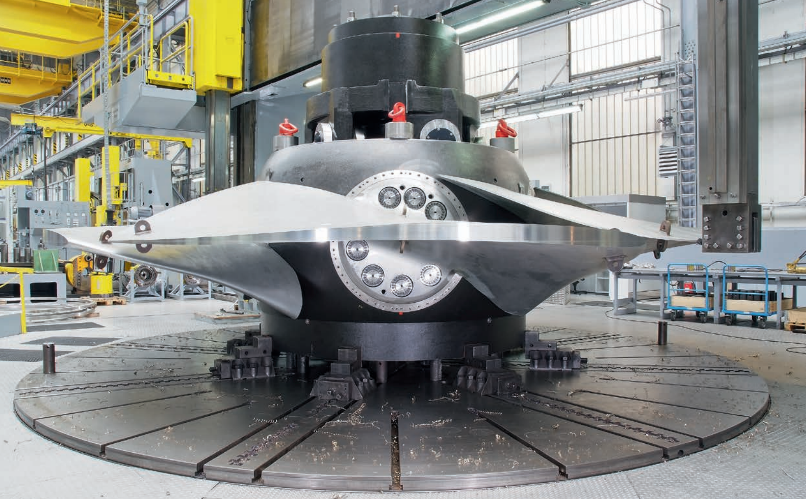
Kaplan-Turbine im Voith-Werk in Heidenheim.
