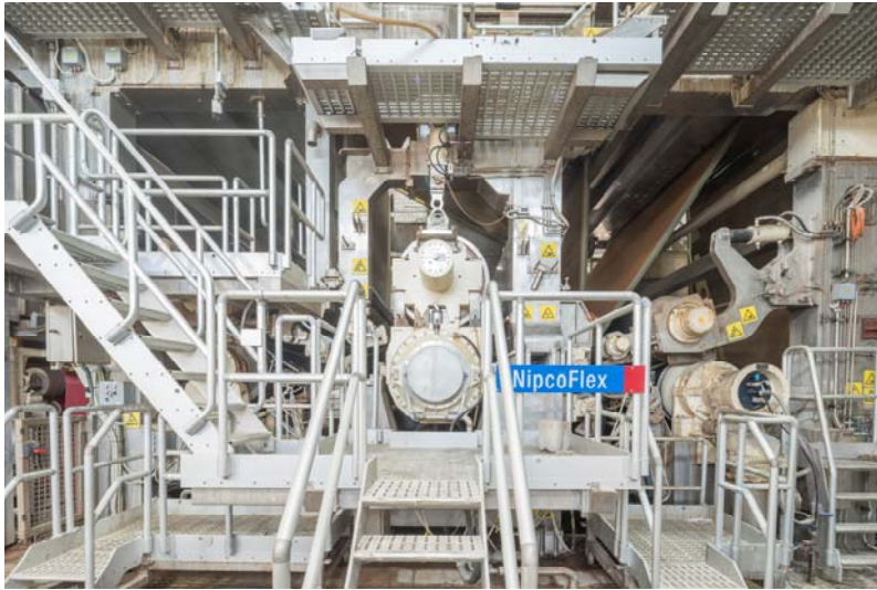
Bild 1: Voith NipcoFlex Schuhpresse Macedonian Paper Mills BM1
