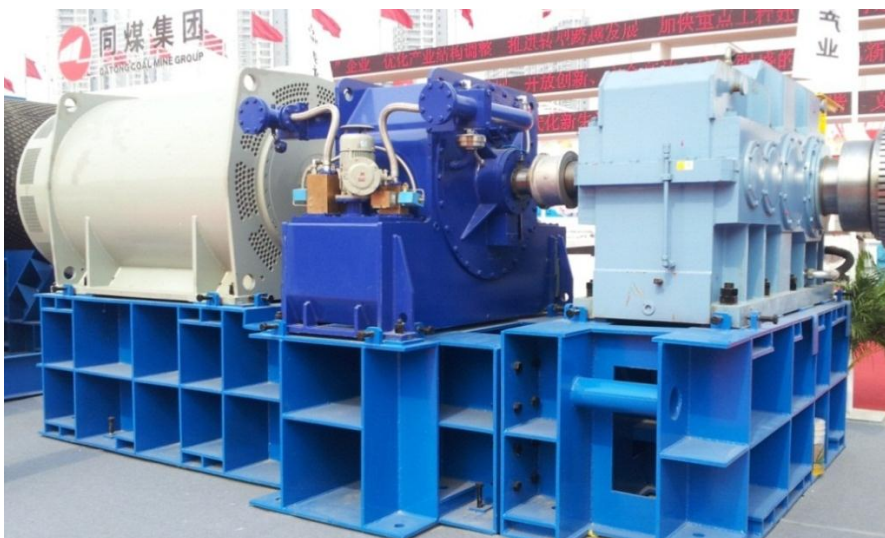
Bild 1: Die leistungsstarke 866 TPKL Turbokupplung von Voith schont den Gurtförderer sowie die Antriebskomponenten vor Schäden und verhindert ungeplante Stillstände.
