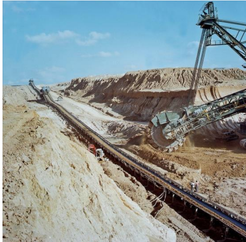
Bild 1: Die „TurboBelt 780 TPXL“ von Voith ist für den Einsatz unter extrem rauen Umweltbedingungen ausgelegt.
