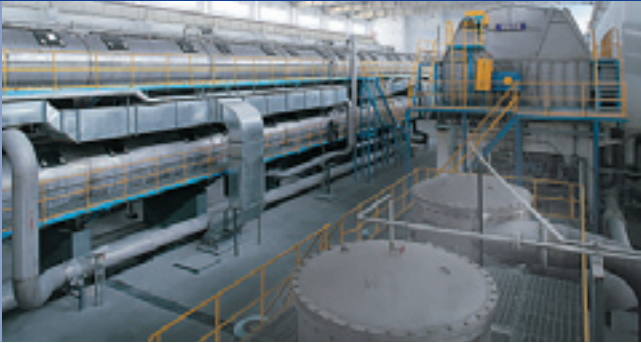
EcoCell Vor- und Nachflotation in Doppelstockanordnung sowie Thune Scheibenfilter. Vorn die erste Stufe der MultiScreen Schlitz-Feinsortierung.
