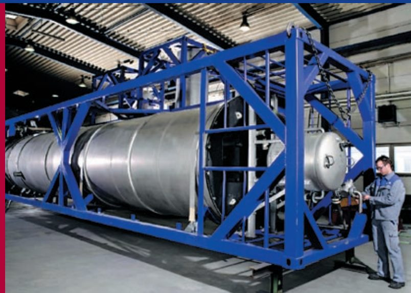
实物尺寸的R2S厌氧EGSB试验反应器为 第一次安装做好了准备
