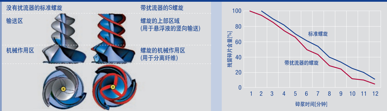
将标准螺旋改成S螺旋后缩短了碎浆时间并改善了碎浆效果
