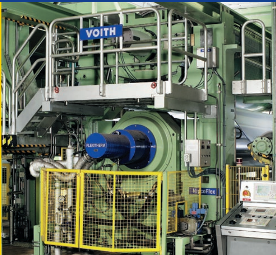
Koehler Kehl SM1涂布机 上的NipcoFlex压光机
