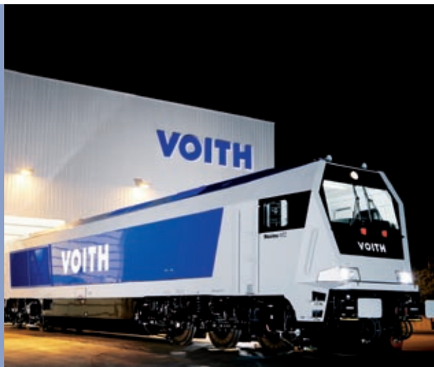
Maxima——全球功率最大的单引擎液力柴油内燃机车
