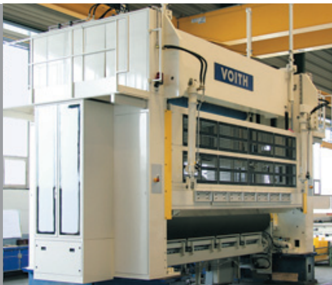
VariFlex-leikkuri tehtaalla asennettuna
