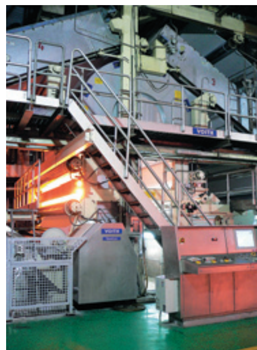
DynaCoat C, IR-kuivain ja HCB-Turn-kääntölaite voitiin asentaa erittäin pieniin tiloihin
