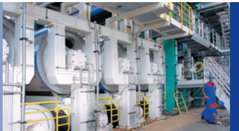
Uuden kartonkikoneen kuivatusosaa Monte Alegren tehtaalla
