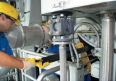
Voith Paper Rollsin tekninen huoltotiimi vaihtamassa kaavariterää
