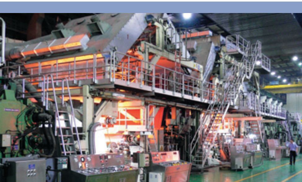
Neljä päällystysyksikköä varmistaa Ningbon valmistaman kartongin huippulaadun
