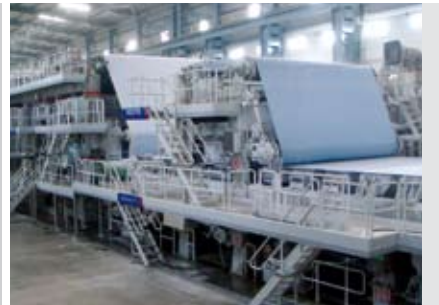
12 Bhigwan PM 2 ist die erste Papiermaschine in Indien mit online Streichverfahren.
