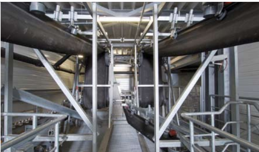
Ein geschlossener Taschenfurtförderer erlaubt den Brennstofftransport auch auf komplizierten Wegstrecken.
