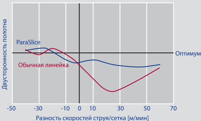
Рис. 1: Анализ структуры бумаги позволяет сделать заключение о двусторонности полотна.
