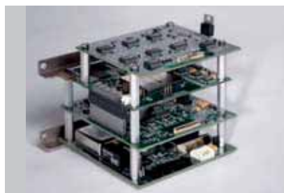
Датчик Voith LSC QuantumSens впервые позволяет абсолютно надежно и при этом исключительно точно измерять толщину полотна.
