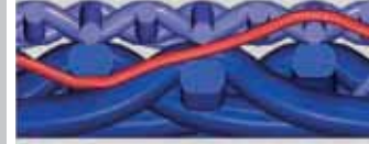
Связующая нить в обычной 3-слойной сетке
