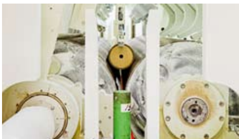
卷芯被精确地插入两个底辊之间
