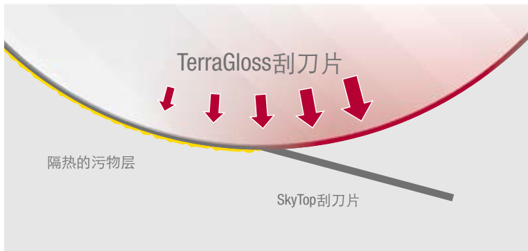
图 3: SkyTop 刮刀片把隔热的污物层清除掉以使热传递最大化
