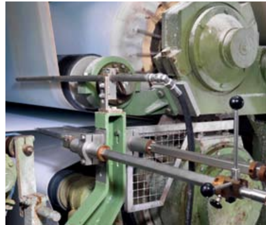
通过安装一个 TailDeflector 引纸系统用于压榨部引纸来提高操作人员的安全性
