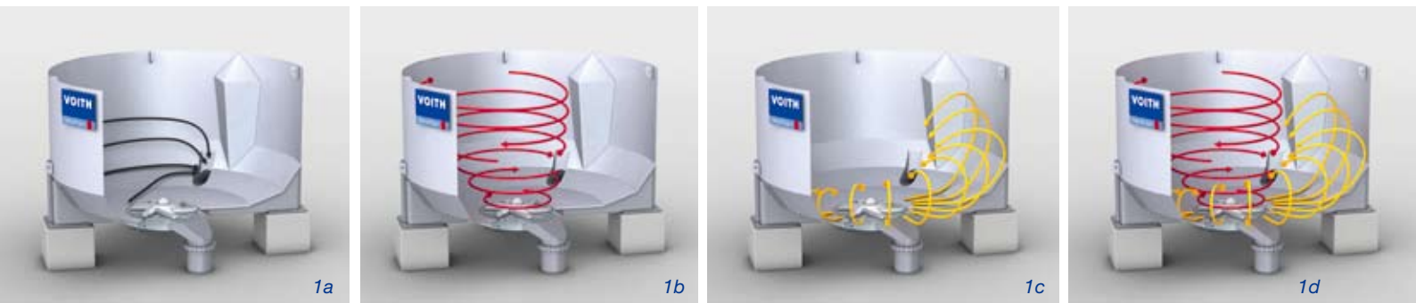
图 1: IntensaPulper-IP-R 碎浆机当中的流型: 重杂质清除 (黑色箭头)、强湍流 (红色箭头) 和低水平湍流区 (黄色箭头)
