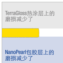
图 7: 高耐磨性防止了边缘区域内的接触, 从而减轻了振动
