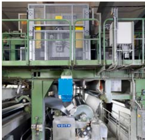
配备了下游红外热风干燥的 SmartCoater 涂布机
