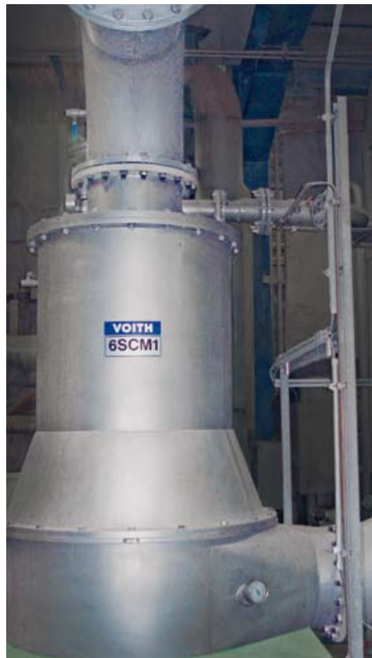
安装于 Smurfit-Kappa 公司在德国的 Zülpich 纸厂的 CycloMech 机械除气系统
