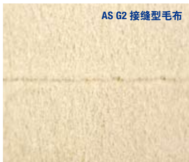
两条用过的压榨毛布的比较。两条毛布都在一台纸板 - 包装纸机上使用了 47 天 (2000 磅 / 线英寸, LNP 压榨)。
