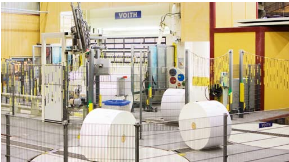
Rollenabtransport mit vollautomatischem Barcode-Label-Anleger.
