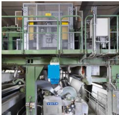
SmartCoater mit anschließender Infrarot- und Lufttrocknung.
