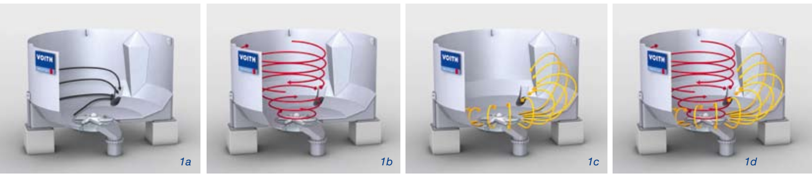
Abb. 1: Strömungsbilder im IntensaPulper IP-R: Abscheidung der Schwerteile (schwarze Pfeile), intensive Turbulenz (rote Pfeile), beruhigte Strömung (gelbe Pfeile).
