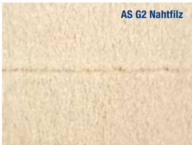
Vergleich zwischen zwei gebrauchten Filzen. Beide waren 47 Tage auf einer Verpackungspapiermaschine (350 kN/m, LNP Presse).
