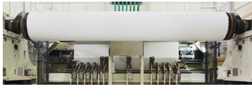
Sicht auf die Schneidestation mit leergefahrenem Tambour.
