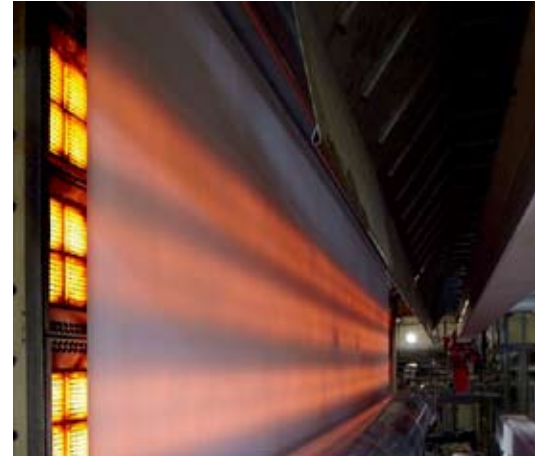
非接触红外烘缸创造完美干燥能力
