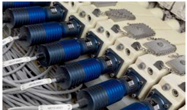
旧的流浆箱可以通过简单的改造办法进行升级
