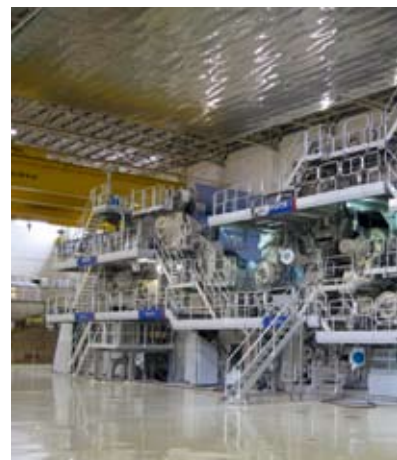
DuoFormer TQv 成形部和串联式 NipcoFlex 靴式压榨
