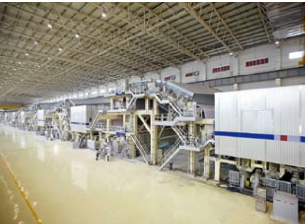
一连串 DynaCoat 在线涂布站
