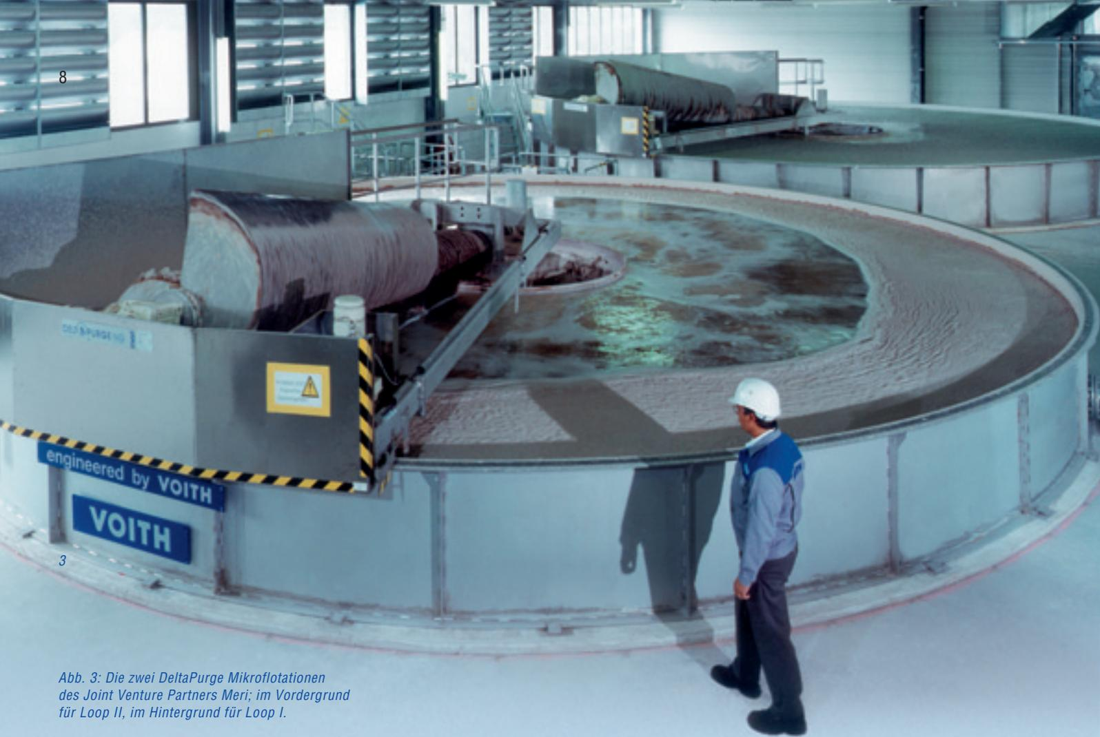
Abb. 3: Die zwei DeltaPurge Mikroflotationen des Joint Venture Partners Meri; im Vordergrund für Loop II, im Hintergrund für Loop I.
