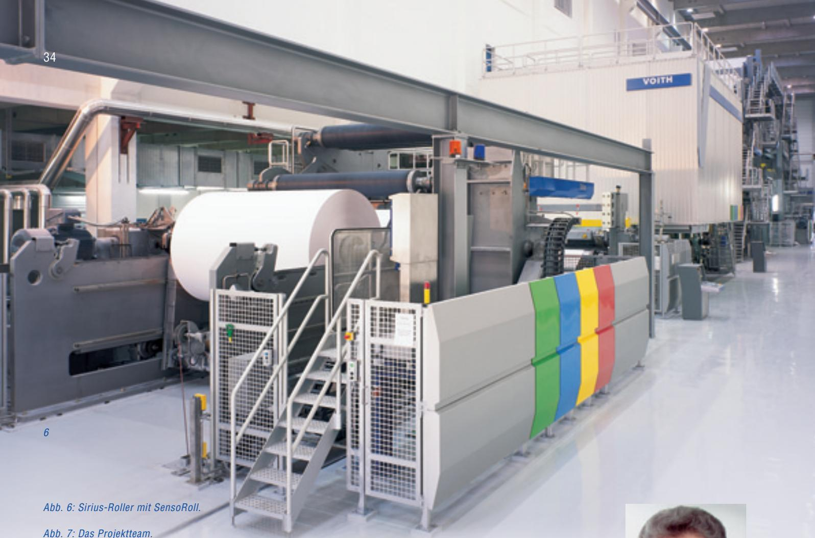
Abb. 6: Sirius-Roller mit SensoRoll.
