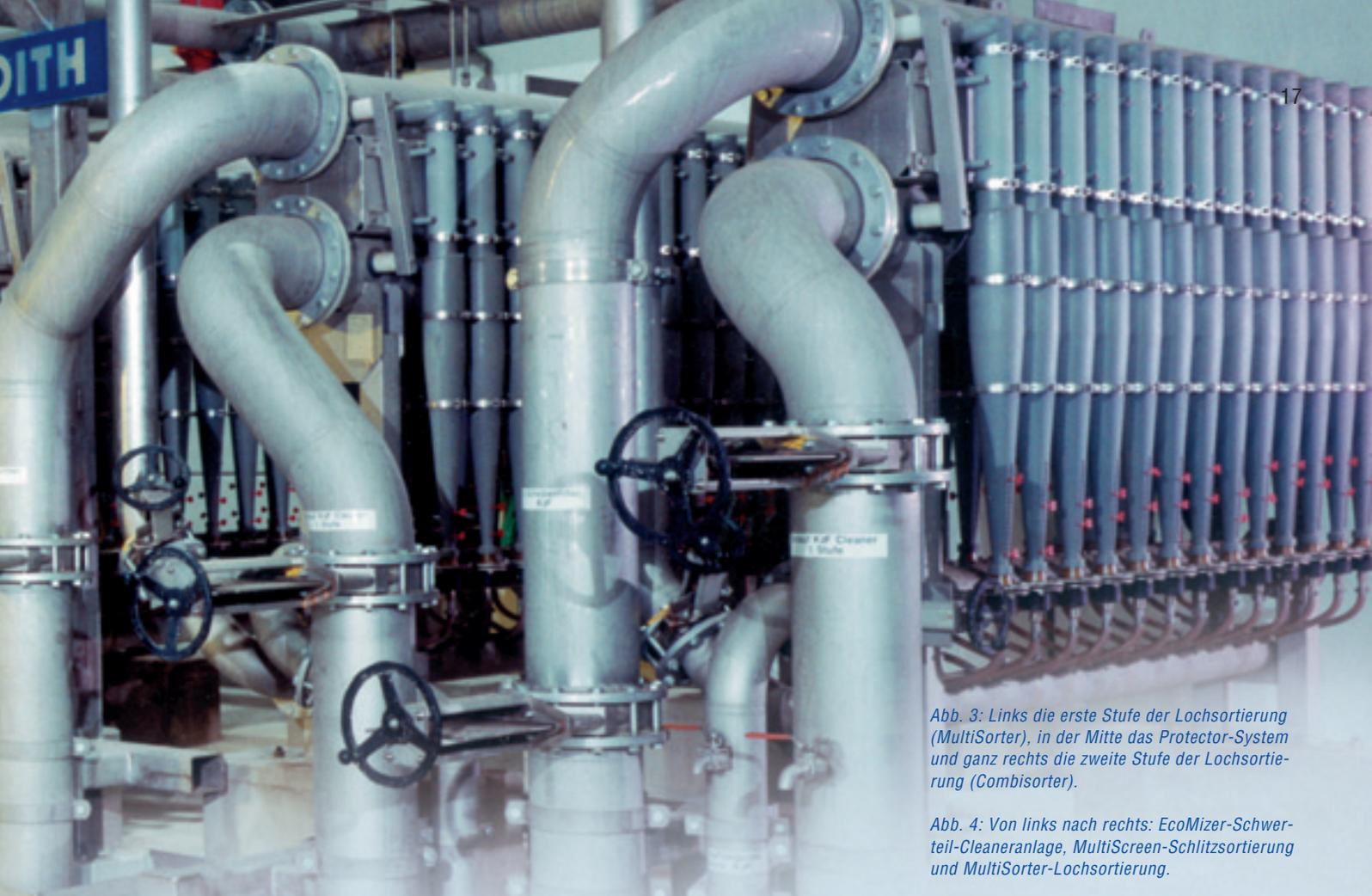
Abb. 3: Links die erste Stufe der Lochsortierung (MultiSorter), in der Mitte das Protector-System und ganz rechts die zweite Stufe der Lochsortierung (CombiSorter).
