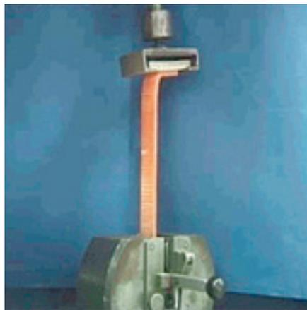
Die Festigkeit und Wasserbeständigkeit der Bindung sind beim AST-System sogar höher als die der einzelnen Schichten, was sich bei zerstörenden Materialprüfungen durch vollständiges Ausbleiben adhäsiver Bruchbilder manifestiert (Abb. 4 und 5).
