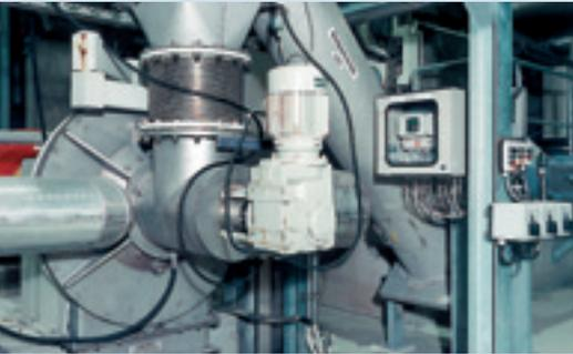
sind dann nicht zu vermeiden. In der neuen Voith Paper Stoffaufbereitungsanlage werden derartige negative Effekte durch den kombinierten Einsatz von Dickstoff- und Dünstoffreinigern (Protector™-System, Abb. 3) vermieden.
