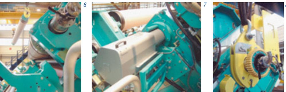
und Unterwalze, hartbeschichtete Thermowalzen sowie die mit Saphir-S-Bezügen bezogenen Mittelwalzen in den Kalander eingebaut (Abb. 6).
