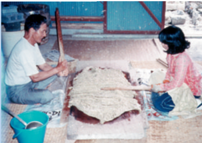
Abb. 6: Die Faserstränge werden auf einem Kirschholzbrett auseinander geschlagen.
