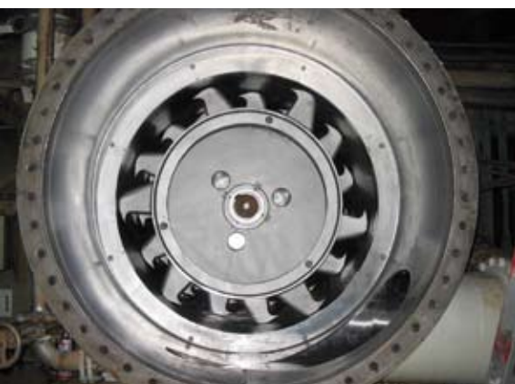
Umgebauter TLA 450 mit MultiFoil-Rotor und C-bar-Siebkorb.
