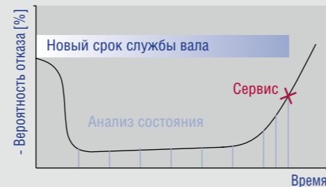
Рис. 3. В основе инновационной программы обслуживания валов компании «Фойт Пейпер» лежит регулярный анализ состояния вала на машине в целях определения пригодности вала для эксплуатации. Результат: более продолжительный срок службы вала без риска выхода из строя.
