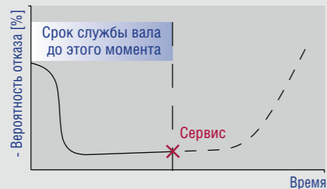
Рис. 2. При обычном профилактическом обслуживании вал демонтируют через заданный промежуток времени и выполняют стандартные сервисные работы, включая упреждающую замену изнашиваемых частей.
