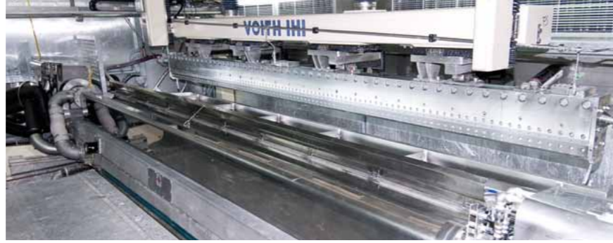
Более высокая концентрация меловальной пасты позволяет экономить энергию в сушильной части.
