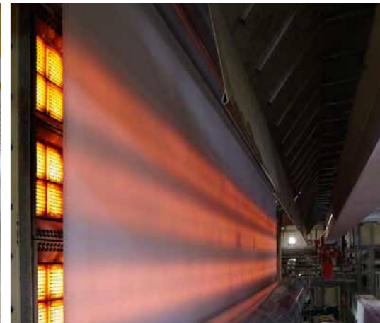
Превосходная эффективность сушильной части благодаря бесконтактной инфракрасной сушке.
