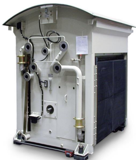
Bild 1: Voith Kühlsystem des englischen Hochgeschwindigkeitszuges (HST) Class 43.
