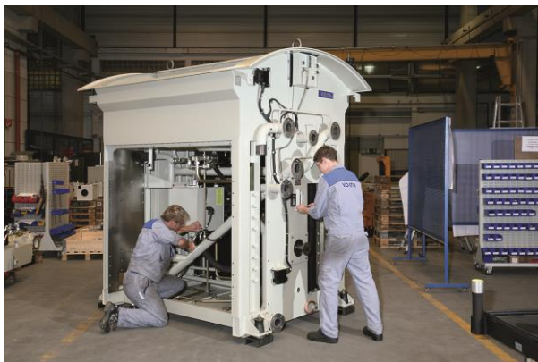
Bild 3: Montage des Kühlsystems für den Hochgeschwindigkeitszug (HST) Class 43.
