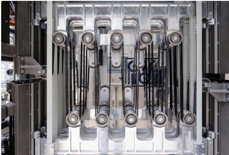
Bild 1: Voith Roving Applicator (VRA): Integrierte Direktfaserablage.
