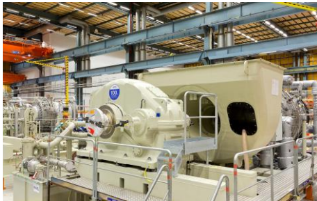
Bild: Das Turbogetriebe zusammen mit der Gasturbine bei Siemens in Schweden. (© Bild: Siemens Finspång)
