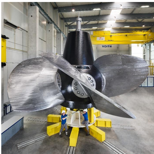
Bildunterschrift 2: Eine vertikale Kaplan-Turbine für das russische Wasserkraftwerk Saratov wiegt 314 Tonnen.
