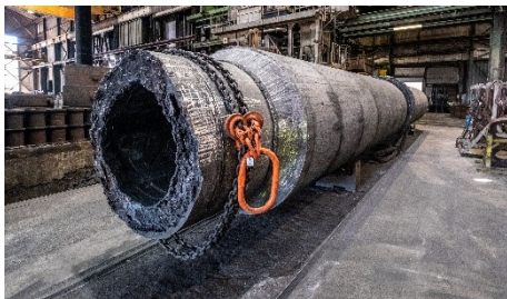
Bildunterschrift 1: Walzenrohling bei Hüttenwerke Königsbronn.
