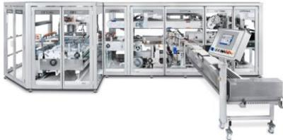
Optima Ingenieure realisieren derzeit Projekte mit Verpackungen aus Papier. Dies ist beispielsweise mit der abgebildeten OPTIMA OSR Verpackungsmaschine für Toilettenpapierrollen möglich. Anlagen wie diese können flexibel von Folien- auf Papierverpackungen umgestellt werden. Optima Maschinen arbeiten mit klassischem Papier und man benötigt für diese Verpackung keine Beschichtungen. (Quelle: Optima)
