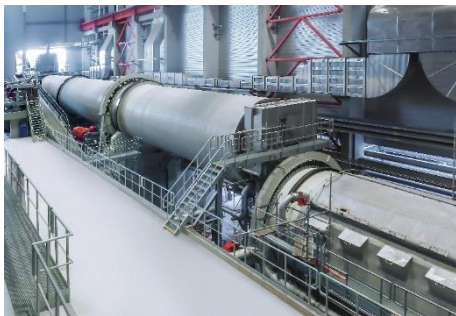
Die Aufbereitungsanlage des Taurus Projekts zählt zur weltweit größten ihrer Art, die IntensaDrum Duo verarbeitet täglich 3.000 Tonnen Altpapier.
