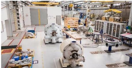
Voith bietet weltweit in 20 Service-Standorten den Aufarbeitungsservice an. Die im Bild hinten stehende Vakuumpumpe wurde bereits aufgearbeitet und läuft nun wieder wie neu.
