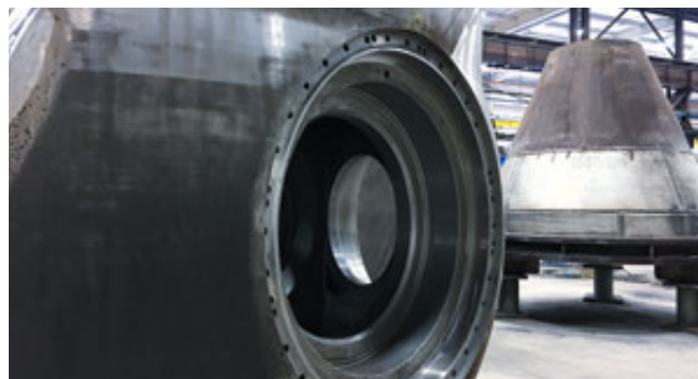
Nach 30 Jahren reif für eine Überholung: Teile von Kaplan-Turbinen bei Voith Hydro in York.
