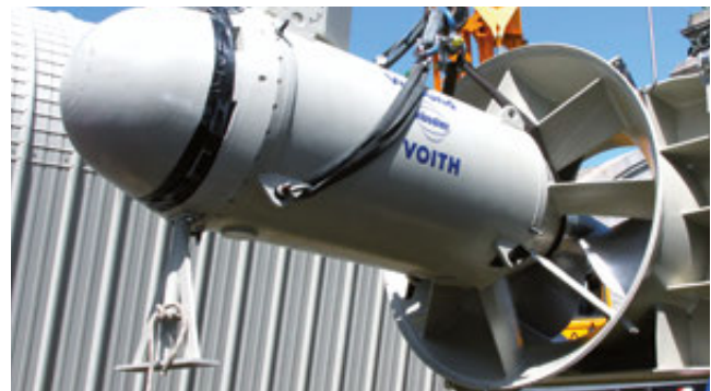
Ende 2016 soll der StreamDiver in Heidenheim ans Netz gehen – die Generator-Turbinen-Einheit eignet sich ideal für den Einsatz in der Brenz.
