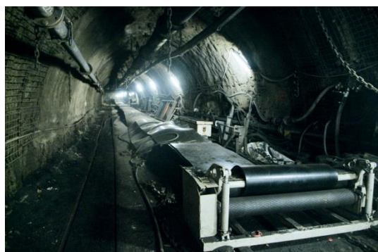
Der Gurtförderer H2 von RAG während des Gurtwechsels. (Bild: RAG)
