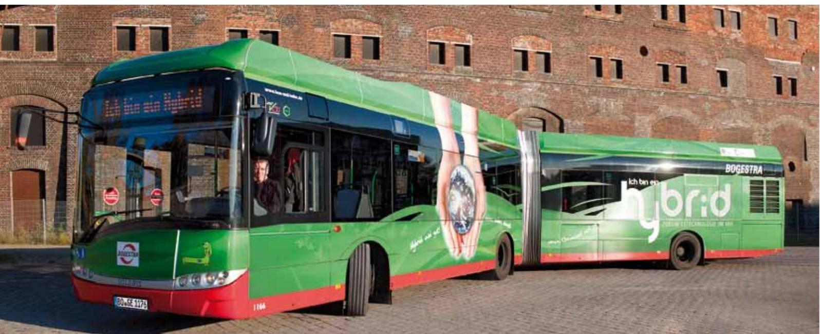
der bei dem Verkehrsunternehmen den Geschäftsbereich Infrastruktur und Fahrzeuge leitet. Im Gegenteil: Der Dieselmotor wird dank der Supercaps geschont, die Kondensatoren selbst sind völlig wartungsfrei. Und der Feinstaubausstoß ist um bis zu 90 Prozent geringer als bei herkömmlichen Dieselfahrzeugen, beim Kohlendioxid sinkt die Belastung um 30, bei den Stickoxiden um nahezu 40 Prozent.
