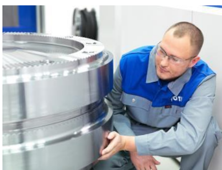
Von Voith Hirth-stirnverzahnter Scheibenverband für eine Gasturbine
