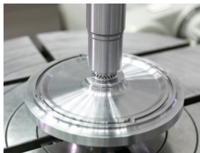
Voith Hirth-Stirnverzahnung als Verbindung von Welle und Laufrad
