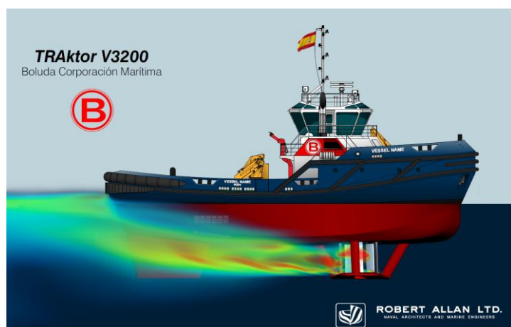
Bild 2: Die von Robert Allan designten Mehrzweckschlepper lassen sich dank VSP-Antrieb selbst auf hoher See präzise manövrieren.
