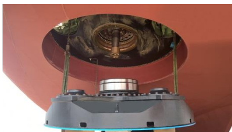
Hauptabdichtungswechsel eines Voith Schneider Propellers.
