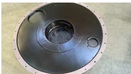
Ein Gehäuseunterteil wird während einer Überholung neu beschichtet.
