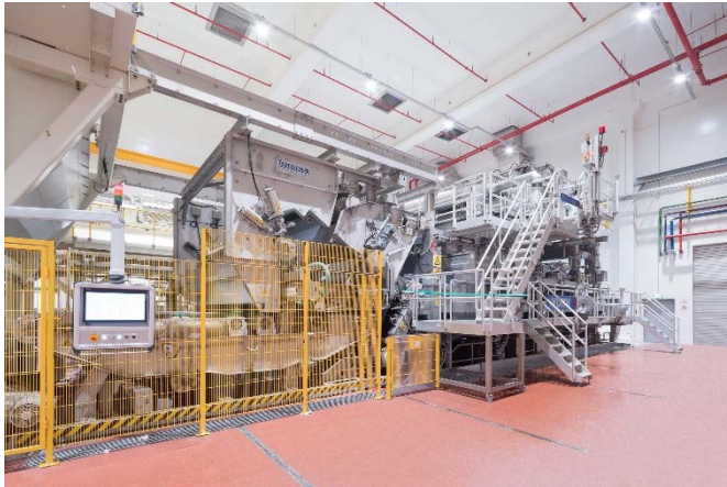
Bild 3: Trützschlers AquaJet für die Vliesverfestigung
