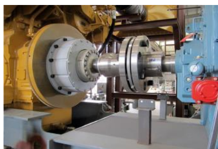
Voith hochelastische K-Kupplung im Antriebsstrang einer Kompressoranlage
