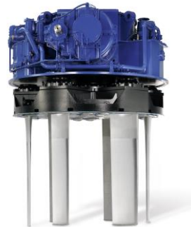
Der Voith Schneider Propeller überzeugt durch seine exakte Manövrierfähigkeit
