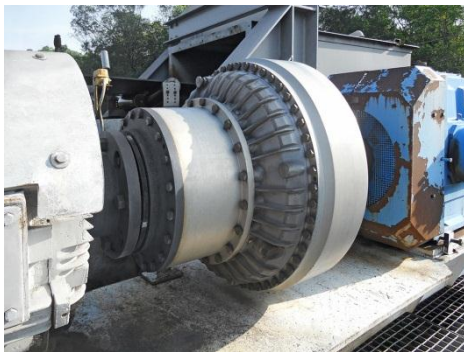
Bild 1: Keine ungeplanten Stillstände seit 1997! Die Tanjung Enim Kohlemine setzt auf die konstant gefüllten TVVS Turbokupplungen von Voith.
