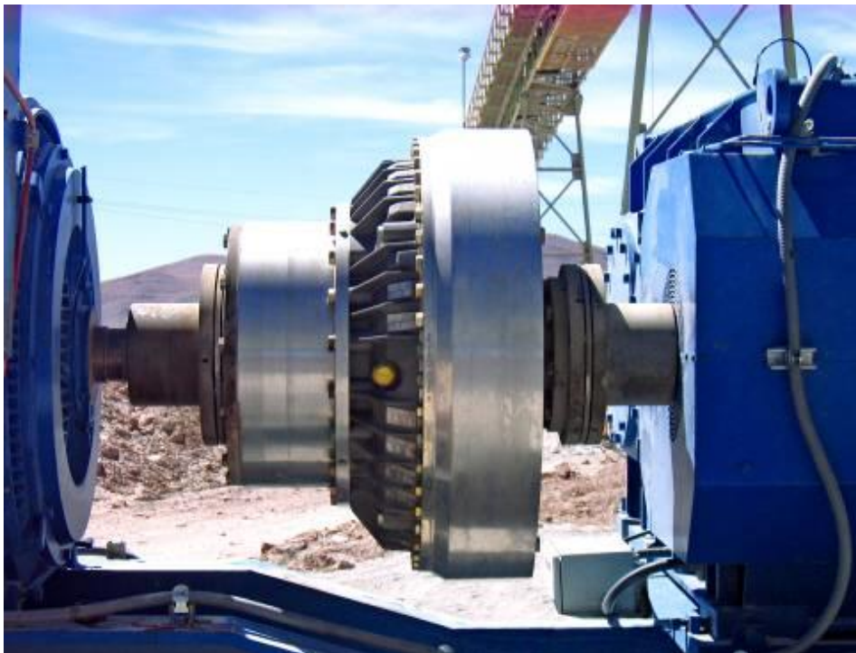
Bild. 1: Die konstant gefüllte Voith Turbokupplung schont die Komponenten im Antriebsstrang von Gurtförderern und erhöht deren Verfügbarkeit.
