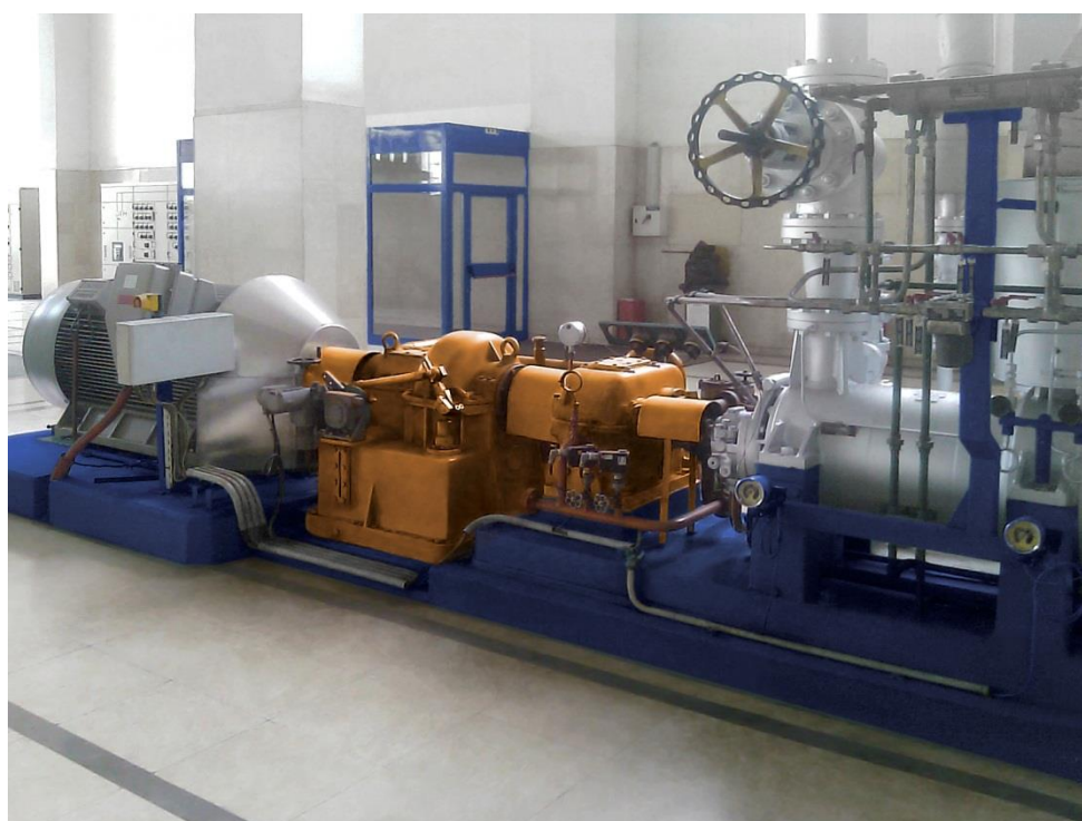
Bild 1: Die Turboregelkupplung (Typ 510 SVL) von Voith arbeitet seit 1956 zuverlässig ohne ungeplante Stillstände.
