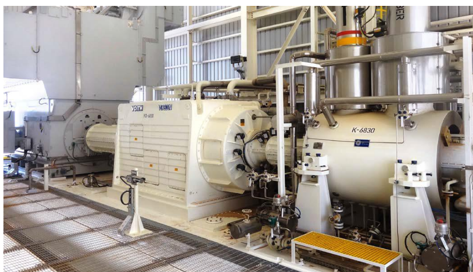
Bild 1: Das regelbare Planetengetriebe Vorecon regelt die Drehzahl der Turbokompressoren im Gasfeld im Oman. Der Vorecon überzeugt mit einem MTBF-Wert von 48 Jahren und einer statistischen Zuverlässigkeit von 99,98 %.
