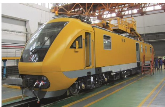
Das Sonderfahrzeug für Oberleitungsinspektion, Typ BR 711 CN, fährt mit Voith Turbogetrieben
