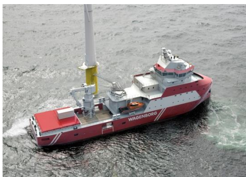
Mit zwei VSP und zwei VIT positioniert das neue W2W Schiff metergenau neben Plattformen und Windkraftanlagen
