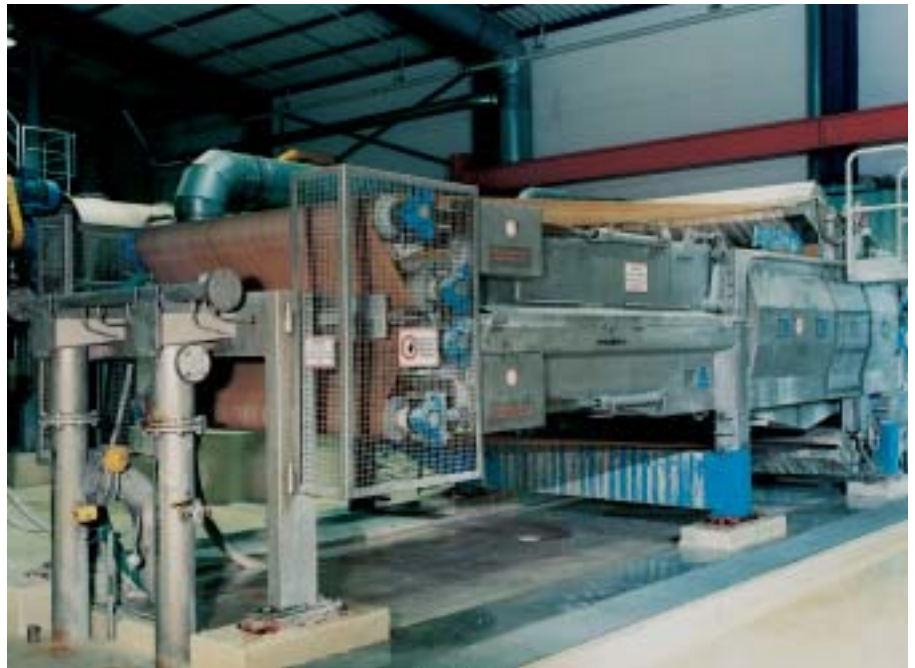
Abb. 6: Disperger mit Heischnecke
