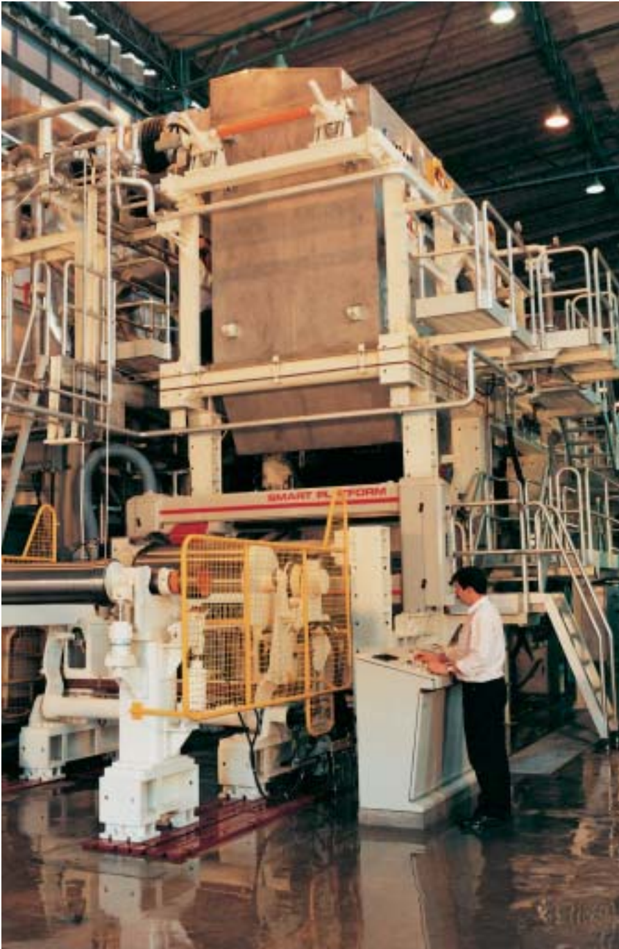
Abb. 10: São Paulo, Brasilien, Versuchspapiermaschine für Tissue mit Doppelsiebblattbildung und Kreppzylinder
