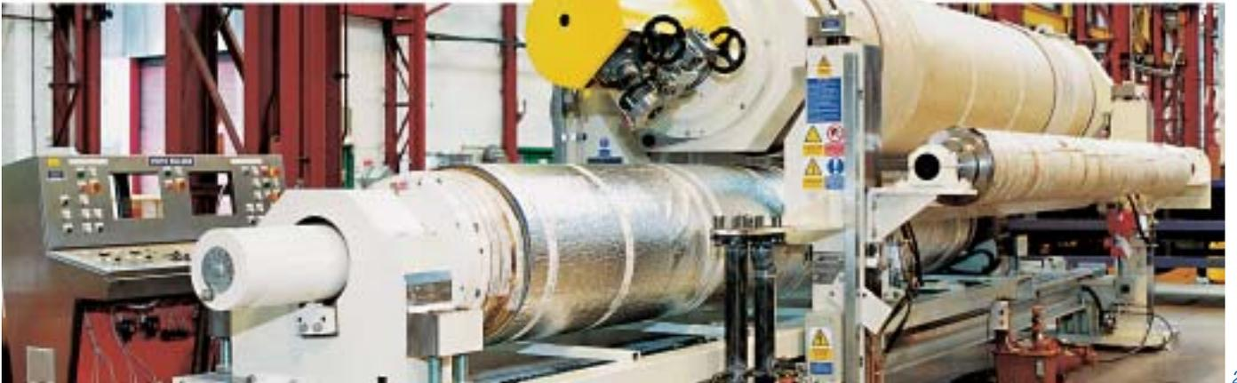
die bisher gebaut wurden. Diese sechs NIPCORECT-Walzen mit insgesamt je 54 Zonen werden in zwei neuen Januskalandern installiert werden. Sie beide verwenden das LoadContRoll-System nach dem neuesten Stand der Technik zur Überwachung und Erkennung von Betriebskräften im Walzenpaket.
