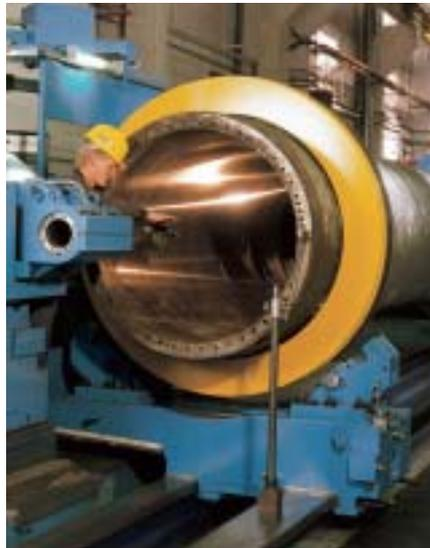
Auch für Einsätze vor Ort sind die Service Center mit mobilen Geräten innovativster Technik ausgerüstet. Beispielsweise zum Schleifen des Zylinders in der Papiermaschine. Durch ein spezielles Schleifverfahren ist ein höchst präzises Schleifer-
