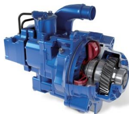
Der Aquatarder SWR bremst mit Wasser
