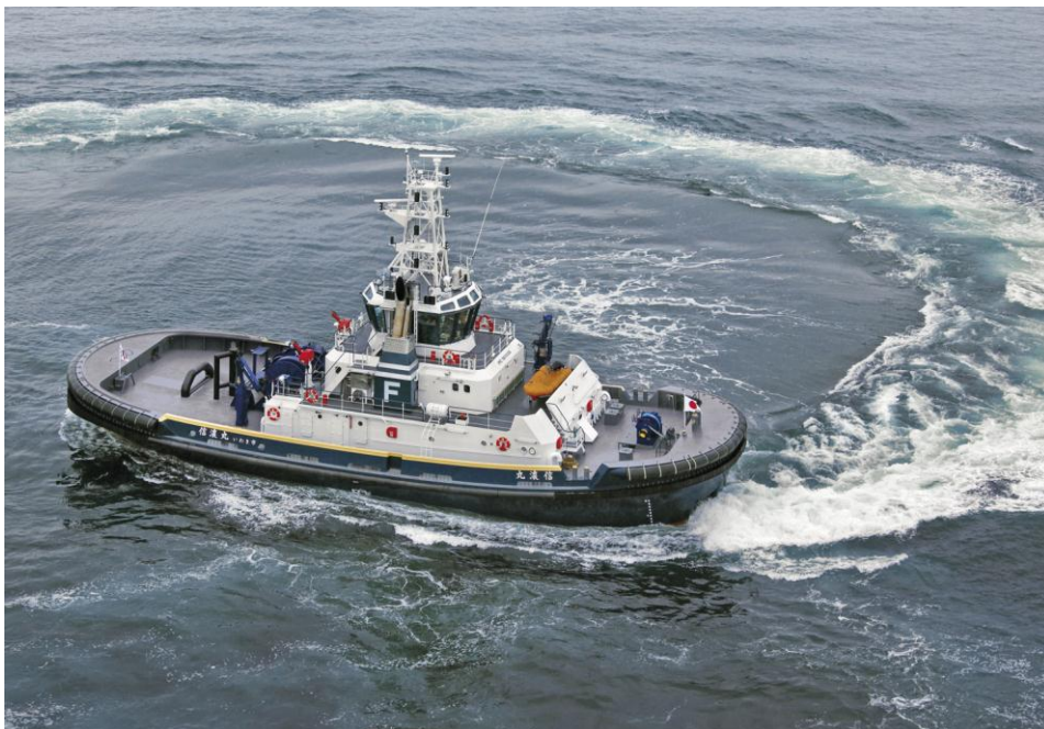
Erster Voith Wassertrecker mit vollelektronischer Steuerung
